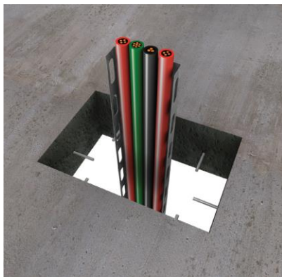
2. Application dans les dalles massives : posez tous les 250 mm des ancrages à frapper d'une longueur de 80 mm au prorata d'un ancrage à frapper par face. Les ancrages doivent être posés sur une profondeur et avec une couverture minimale de 40.
