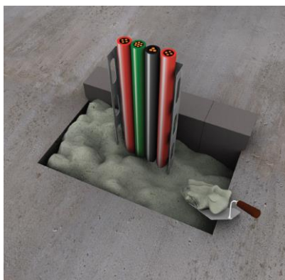
5. Remplissez le reste de l'ouverture de PROMASTOP®-M mortier résistant au feu. En fonction des dimensions de l'ouverture, il faudra éventuellement appliquer une couche supplémentaire pour obtenir la bonne épaisseur.
